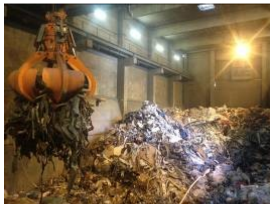
Obr. č. 2: Odpad je během procesu zpracování homogenizován
