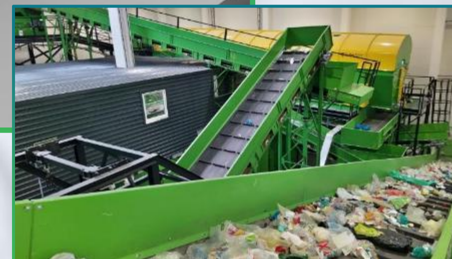
Rotační buben síta 50 / 350 mm
